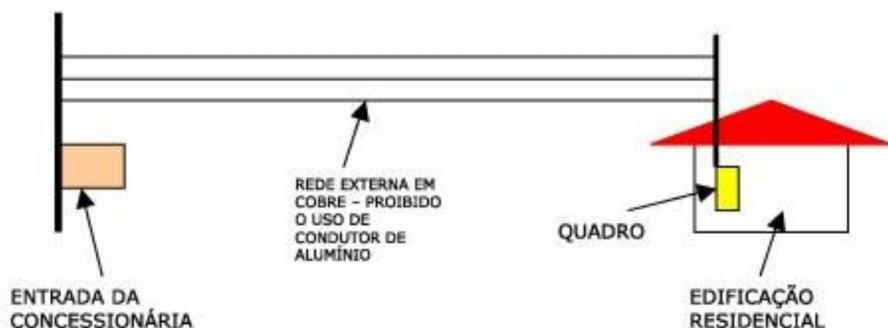
Figura 1 – Exemplo de proibição de uso de condutor de alumínio em rede aérea externa a uma edificação residencial.
